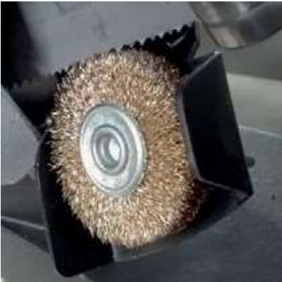
Hintere Sägebandführung mit Reinigungsbürste
